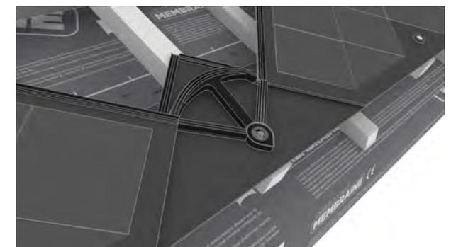
Anmerkung: Korrekte Position der Dichtecke gemäss Bild beachten! Die Dichtecke wölbt sich etwas, bis der nächste Ziegel darauf liegt. Keinesfalls Dichtecken abschneiden, ausser am Ortgang
